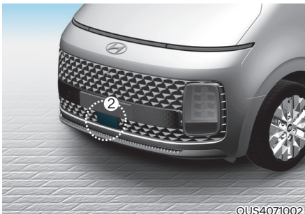
[1]: Kamera depan [2]: Radar depan
