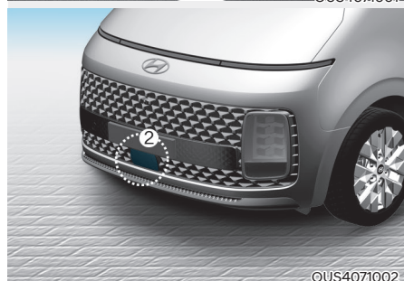
[1]: Kamera depan, [2]: Radar depan
