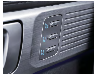
운전석 에르고 모션 시트 운전석 자세 메모리 시스템
