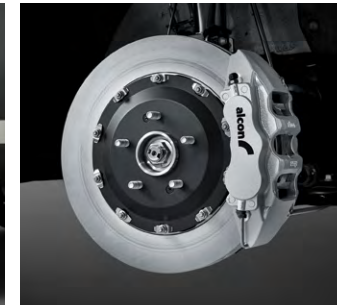
알콘(alcon) 모노블록 브레이크 시스템
