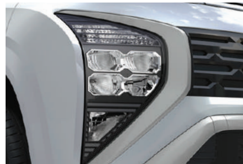
LED Headlights ไฟหน้า LED แบบมัลติรีฟเล็กเตอร์
